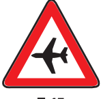
T-17 Havaalanı-Havalimanı (Alçak Uçuş)
